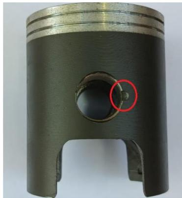
Para motores Yamaha, pistón original del motor o de mercado de reposición, de libre origen, ver dimensiones en Plano N° 2 y Plano N° 3. Se permite utilizar pistones de industria nacional Marca RR de acuerdo al plano N° 4. Se permite intercambiar pistones entre motores RD y DT.
